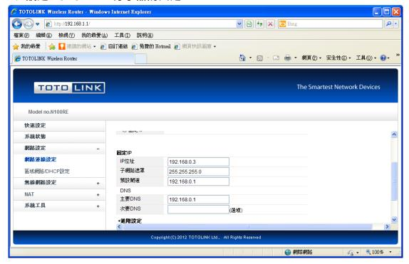
2. 確認硬體設備 CTR100、CTR230 IP 需與分享器 IP 相同網域及子網路遮罩。
